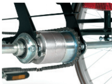
23 - Différentiel pour les deux roues arrière
